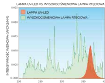
Na podstawie: Charakterystyka emisji i właściwości utwardzających źródeł światła UV-LED - "Characterizing the Output and Curing Capabilities of Solid-State UV LED Sources, Paul Mills, Phoseon Technology"
