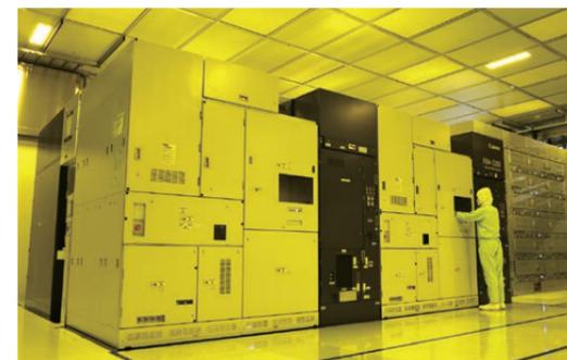
Test de machines de lithographie par nano-impression pour la production en série de semi-conducteurs chez un fabricant de mémoires
