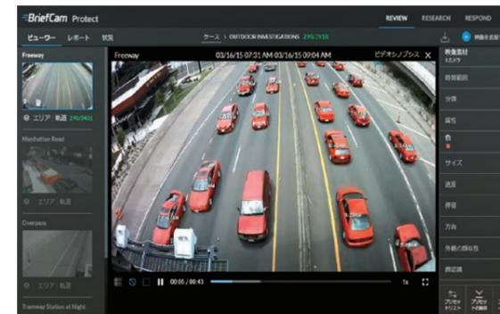
Le logiciel d'analyse de contenu vidéo de BriefCam synthétise les longues séquences vidéo et les filtre afin de détecter un objet cible, ici en l'occurrence les voitures rouges
