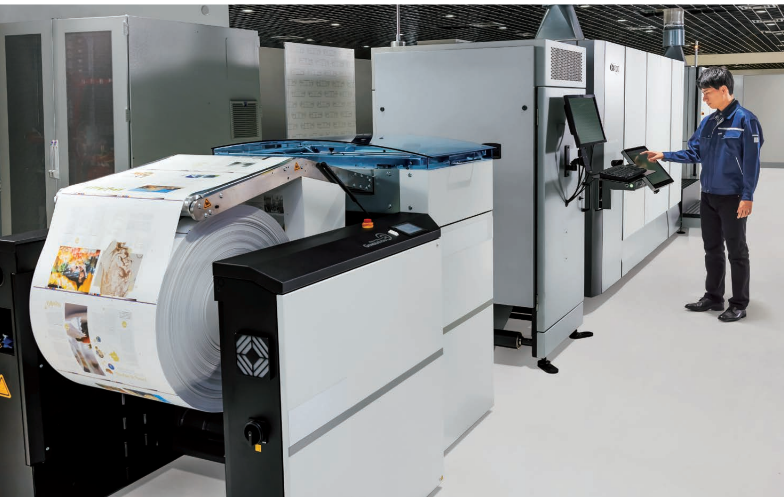
Une imprimante à alimentation continue qui permet une impression numérique ultra-rapide et de haute qualité.
