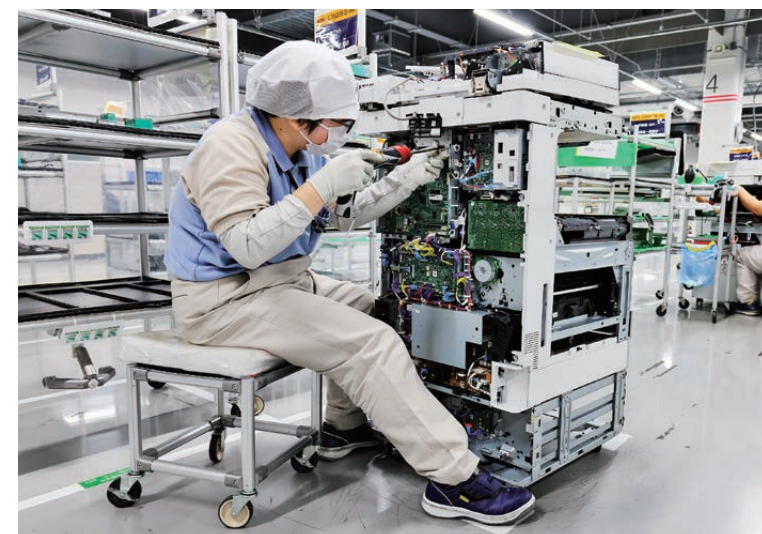
Les périphériques multifonctions d'entreprise sont reconditionnés afin d'être réutilisés
