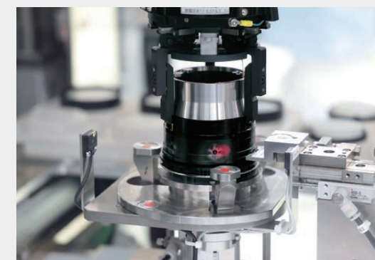
Ligne de production automatisée des objectifs interchangeables
