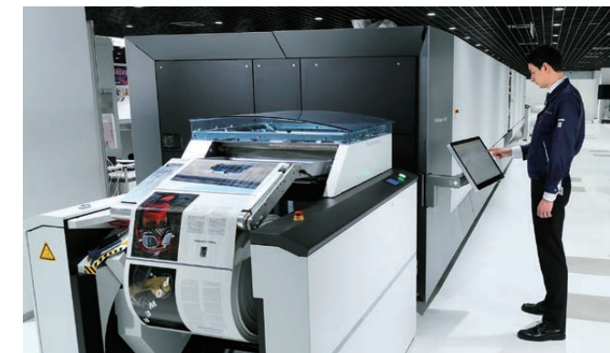
Les presses à alimentation continue offrent une impression ultrarapide et une qualité d'image supérieure
