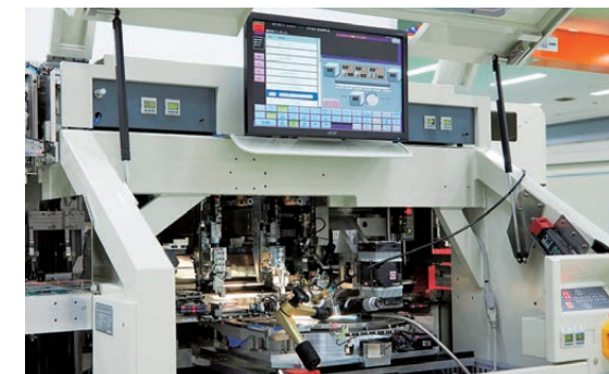
Microsoudes de puces de Canon Machinery, utilisée pour fixer des puces pour semi-conducteurs
