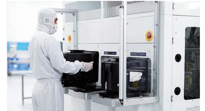
Les équipements de pulvérisation de Canon ANELVA déposent un film uniforme de taille nanométrique sous vide
