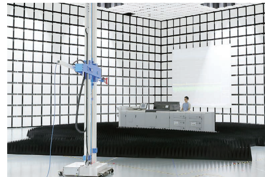
Certifiée ISO/IEC 17025, la chambre anéchoïde de Canon répond aux exigences d'un essai par des tiers
