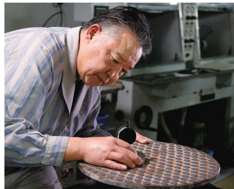
Technicien « Master Craftsman » pour le polissage des objectifs
