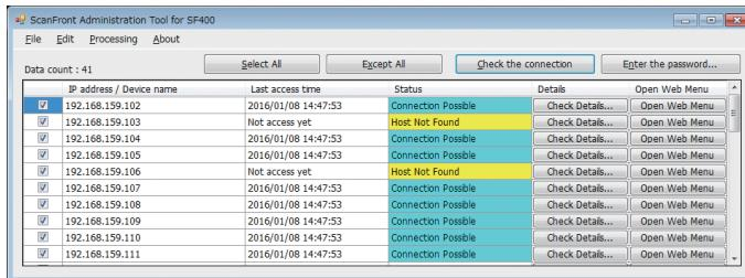
Softver Administration Tool omogućava upravljanje većim brojem skenera ScanFront u isto vrijeme. Možete provjeriti status skenera ScanFront na mreži, konfigurirati postavke, upravljati korisnicima, izraditi rezervne kopije i obnoviti konfiguracijske podatke.
