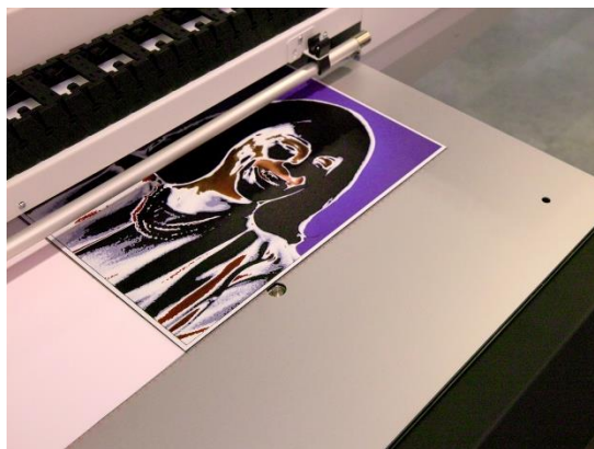
Jusqu'à 100 couches d'encre pour des détails perceptibles : l'imprimante Canon Arizona crée un portrait tactile avec un relief allant jusqu'à 4 mm.
