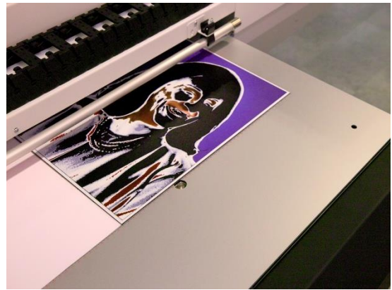
Bis zu 100 Farbschichten für fühlbare Details: Der Canon Arizona Drucker erzeugt ein taktilen Porträt mit bis zu 4 mm Reliefhöhe.
