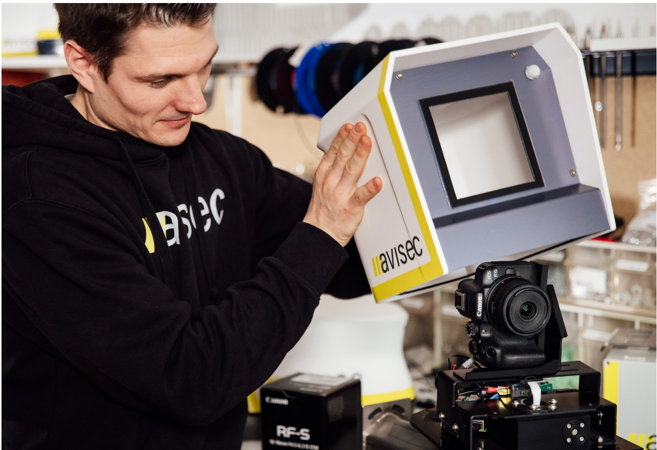
Onderhoudsmonteur Simon Fenner plaatst een weerbestendige behuizing over de Construction Camera Pro
