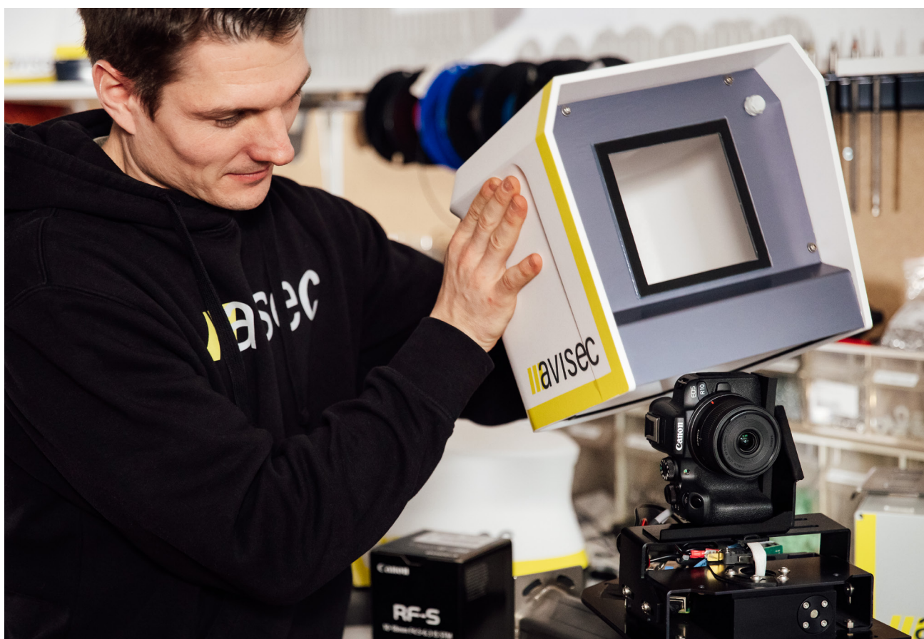
Il tecnico dell'assistenza Simon Fenner installa una custodia resistente agli agenti atmosferici sulla Construction Camera Pro
