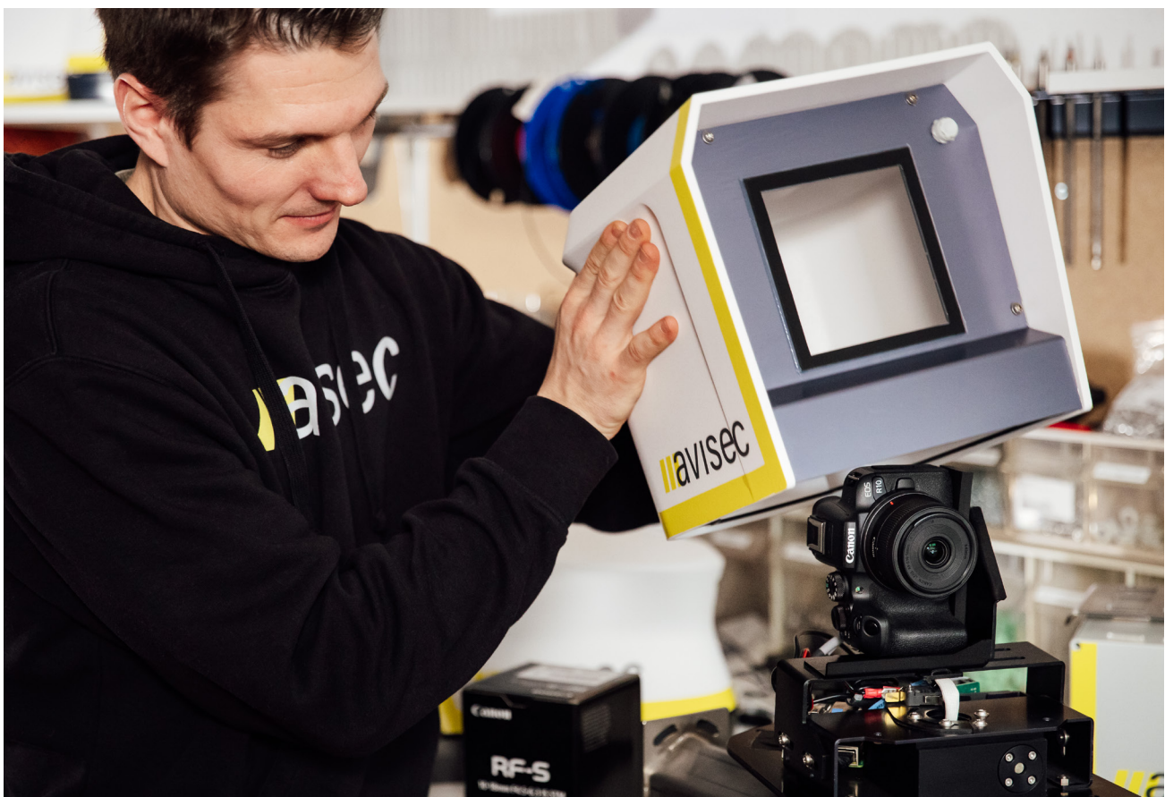
Servicetechniker Simon Fenner montiert ein wetterfestes Gehäuse an der Construction Camera Pro
