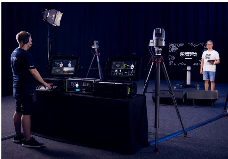
De même, les capacités d'autofocus des caméras PTZ CR-N500 sont l'une de leurs fonctionnalités de prédilection. Les caméramans comme Ville peuvent donc contrôler plusieurs unités de manière transparente - avec un souci en moins. Le système autofocus CMOS Dual Pixel est identique à celui de caméras cinéma haut de gamme comme l'EOS C300 Mark III. L'autofocus du modèle PTZ offre donc une qualité cinéma dans une caméra beaucoup plus compacte et abordable.
