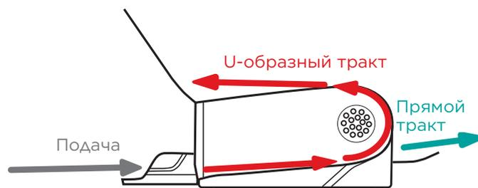
Дополнительный прямой тракт подачи бумаги обеспечивает эффективное сканирование пластиковых карт и толстых документов.
