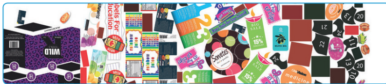
Sammelform des Freiform-Nestings zur optimalen Ausnutzung von Substraten
