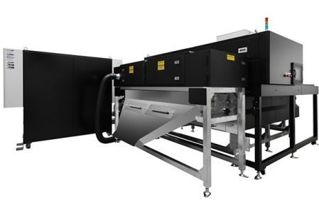
Installation de tri de plastiques TR-S1510
