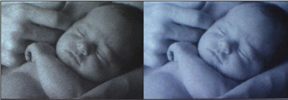
MAXIFY GX4050 çıktısı (solda) ile EcoTank ET-4850 karşılaştırması; Canon daha doğru bir gri tonu üretirken Epson çıktısı daha maviye dönük, daha soğuk bir renk sıcaklığı sergilemektedir.
