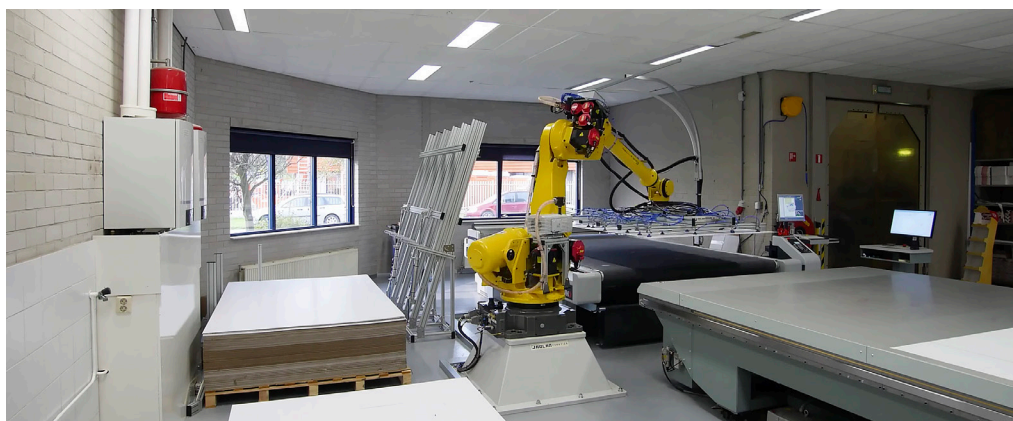
Zautomatyzowana obsługa podłoży w połączeniu z ploterem Arizona w firmie Van Vliet Printing B.V.
