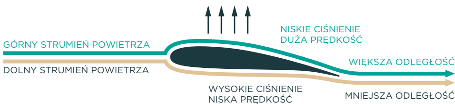
RYSUNEK 25: Wpływ prawa Bernoulliego na skrzydło samolotu
