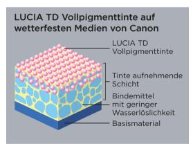
Die Farbpigmente dringen in die Tinte aufnehmende Schicht ein, verbinden sich fest mit ihr und schützen sie vor Feuchtigkeitseinfluss und UV-Strahlung. Zusätzlich enthält die Tinte aufnehmende Schicht ein Bindemittel mit geringer Wasserlöslichkeit, wodurch die Drucke wetterbeständig werden.
