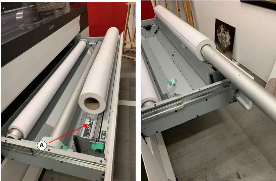
Поместите носитель в отсек станции загрузки рулонов (А). Короткий бортик системы подачи облегчает установку втулки. Рулон необходимо отцентрировать на втулке. Ее размер должен соответствовать размеру носителя (руководство по подбору напечатано на самой втулке).
