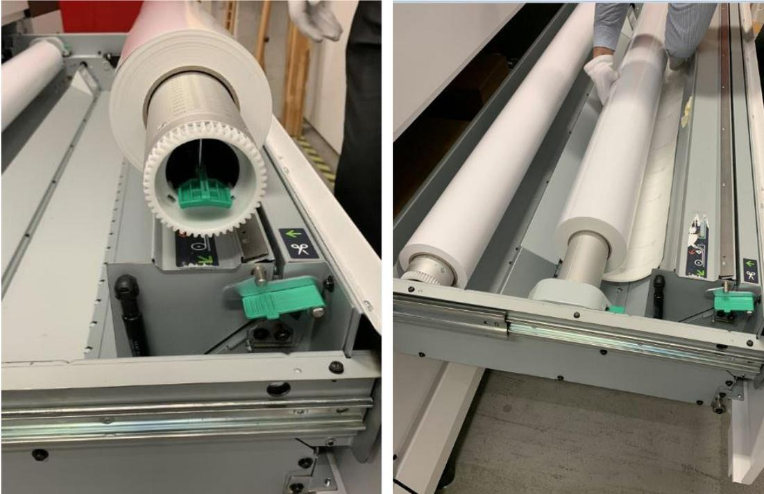
Для простоты все доступные пользователю рычаги и рукоятки имеют зеленый цвет. Снова разместите рулон в системе подачи кромкой к себе и вручную заправьте конец листа в металлическую направляющую. Если загрузка прошла успешно, раздастся звуковой сигнал. Остальной процесс автоматизирован — для его завершения нужно только подтвердить тип и ширину носителя на панели управления.
