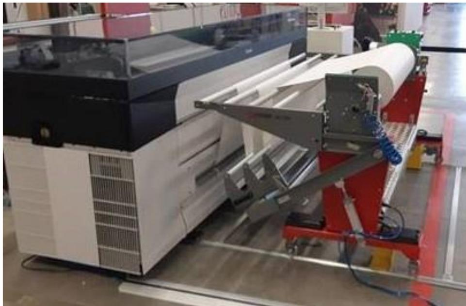
Устройство рулонной подачи Jumbo Roll, поставляемое сторонним производителем, обеспечивает долгую бесперебойную работу принтера и позволяет использовать рулоны материала весом до 400 кг. Эта модульная система, объединяющая в себе функции устройства для резки и намотчика — причем с возможностью как внутренней, так и внешней намотки, — разработана специально для непрерывной подачи материала при печати обоев.
