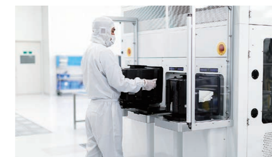
Les équipements de pulvérisation cathodique de Canon ANELVA jouent un rôle décisif dans la fabrication de dispositifs à semi-conducteurs.
