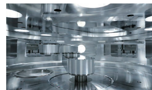
Unité de transport d'équipements de fabrication d'écrans OLED
