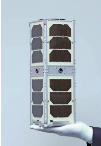
Allant plus loin dans la miniaturisation, le CE-SAT-III présente les dimensions suivantes : 100 mm x 100 mm x 300 mm
