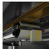
**Il sistema di manutenzione automatica** pulisce le teste di stampa quando necessario senza alcun intervento dell'operatore
