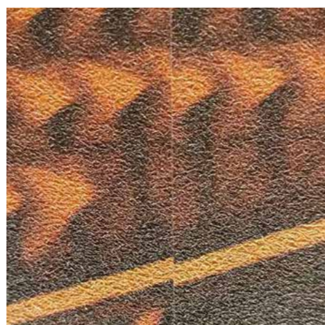
Due pannelli non corrispondenti a causa di differenze nelle dimensioni
