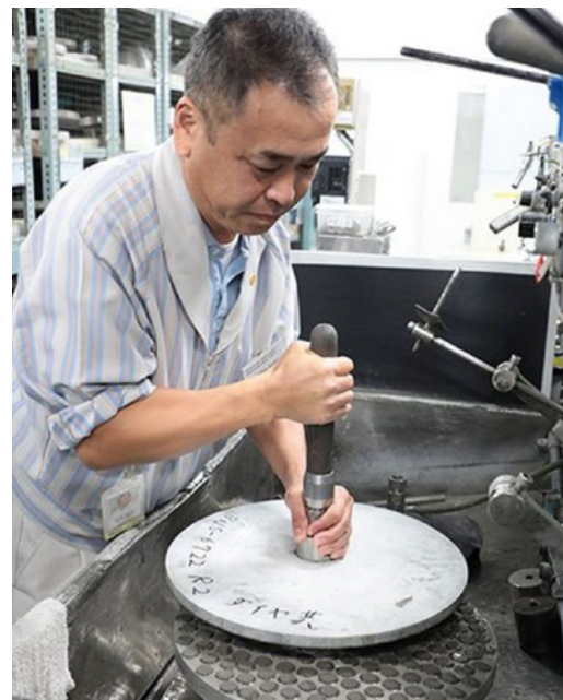
Das Herzstück der Objektivherstellung sind meisterhafte Handwerker. Hier beginnt Toshi Saito mit der Herstellung der ursprünglichen Linse, die anschließend von automatisierten Maschinen weiterverarbeitet wird. Aufgenommen mit einer Canon EOS 5D Mark IV mit einem Canon EF 24-105mm f/4 L IS II USM Objektiv. © Nigel Atherton
